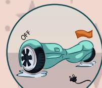
После попадания в лужу гироскутер стоит в обязательном порядке насухо вытереть. Также стоит дождаться, пока устройство полностью высохнет, лишь после этого опять включить его или ставить на зарядку.
